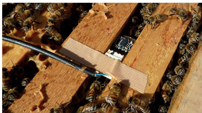
Photo 12. Détail d'un capteur de température qui enregistre les variations au cours du temps dans une ruche (© Emmanuel Ruffio)
